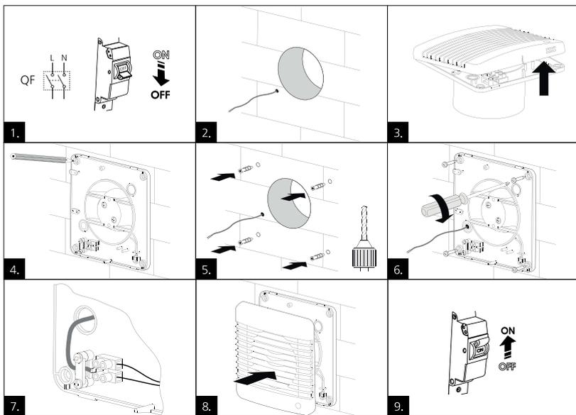
Вентиляторы модификаций DWA-XX-X-X-6X, DWA-XX-X-X-7X предназначены для установки на стену.
