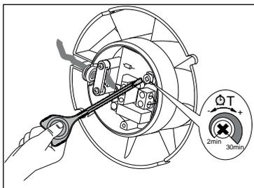
**ВНИМАНИЕ!** Схема таймера находится под сетевым напряжением.
