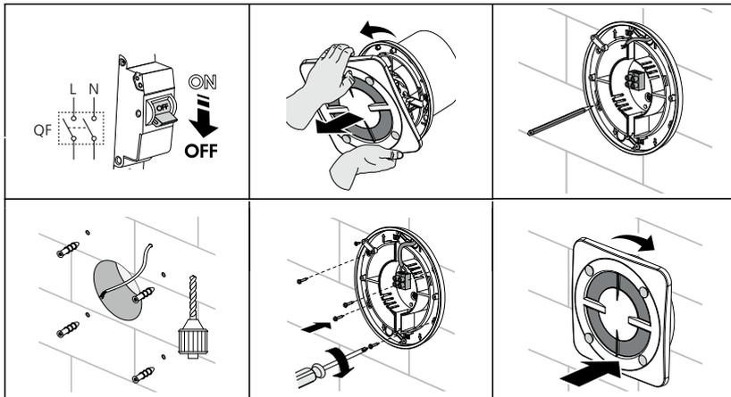
Последовательность монтажа вентиляторов моделей: DWC-100B-14, DWC-100B-16, DWC-100B-8, DWC-125B-18, DWC-125B-23, DWC-125B-17 показана на рисунке:
