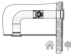
Последовательность монтажа вентиляторов моделей DCA-100F-14, DCA-100F-16, DCA-100F-8, DCA-125F-18, DCA-125F-23, DCA-125F-17, DCA-125F-28 показана на рисунке:
